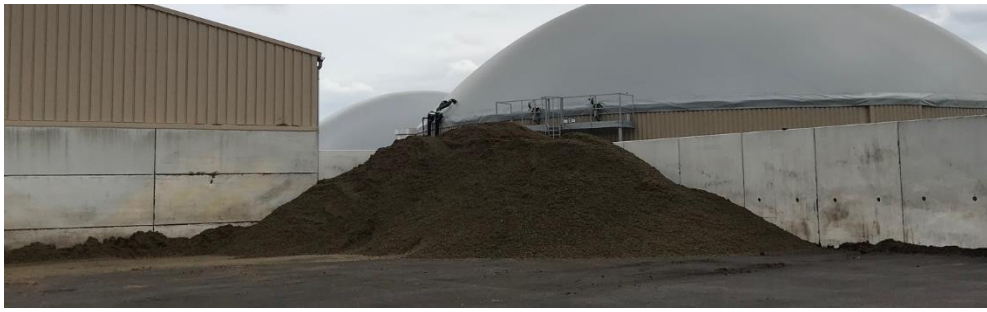
Figure 6 : Digestat solide entreposé
